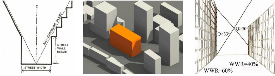
Şekil 4: Gökyüzüne maruz kalma analizi; kesit (solda) [26], kuzey-batı yönünden perspektif (ortada) [27], gökyüzü açısı hesaplaması (sağda) [10]
