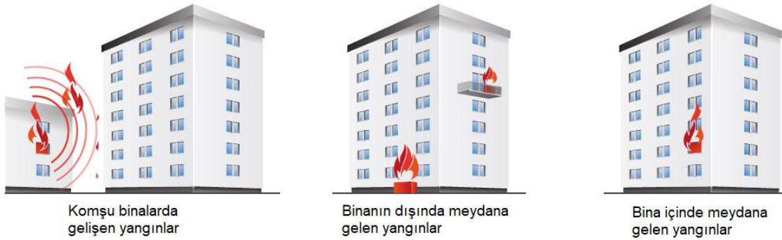
Şekil 1: Cephelerde yangın oluşma şekilleri
